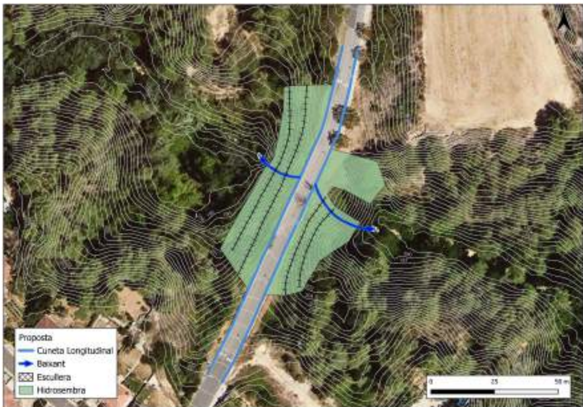
Figura 48. Proposta alternativa corresponent a la instal·lació de dos drenatges longitudinals i una hidrosembra superficial a cada vessant
