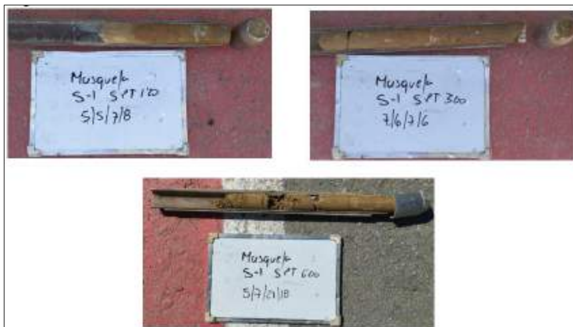
Figura 11 Assaigs SPT realitzats en el sondeig S3
