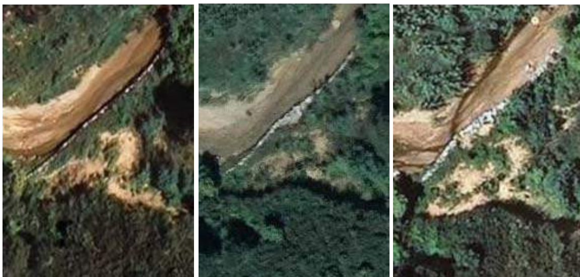
Fotografia 5. Ortoimatges dels anys 2010, 2011 i 2012 on s'observa la progressiva deformació de l'escullera de la subàrea C.
