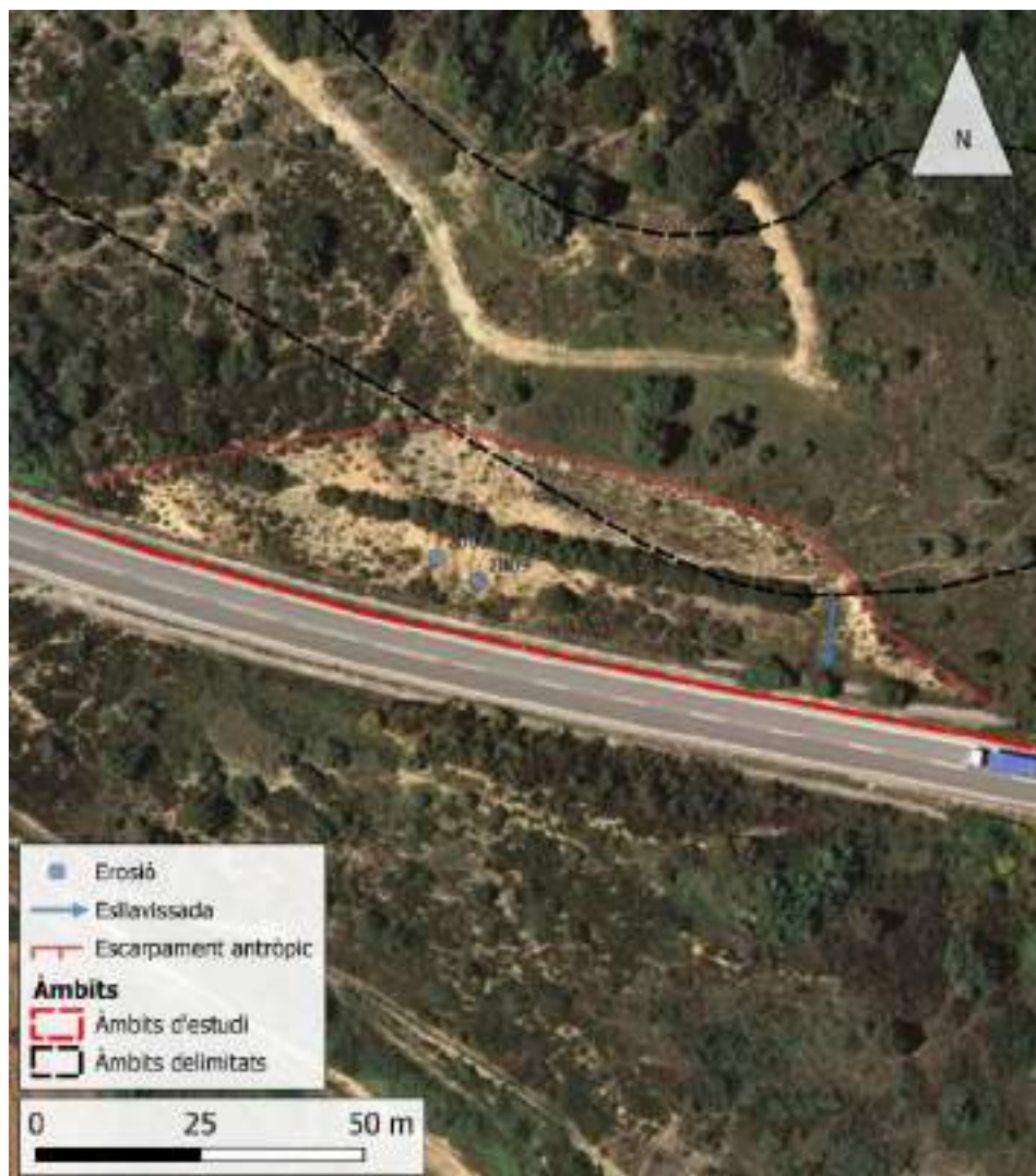
Figura 7: Talús de la carretera B-224 que afecta al sector de Can Bros. S'hi poden observar, sobre l'ortoimatge de 2009 les erosions, i la cicatriu i dipòsit del lliscament del marge dret.
